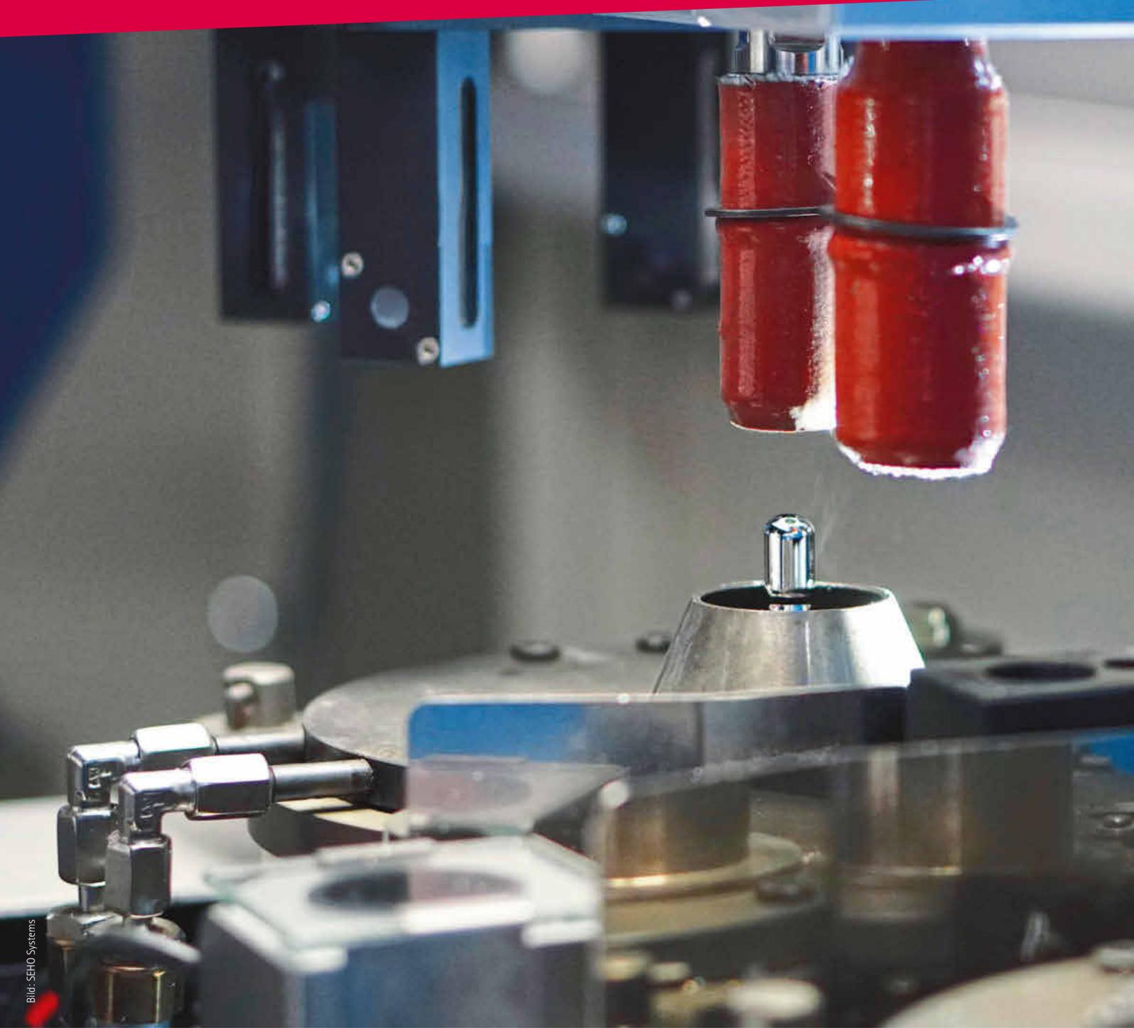
Automatische Reinigung von Lötdüsen im Selektivlötprozess
