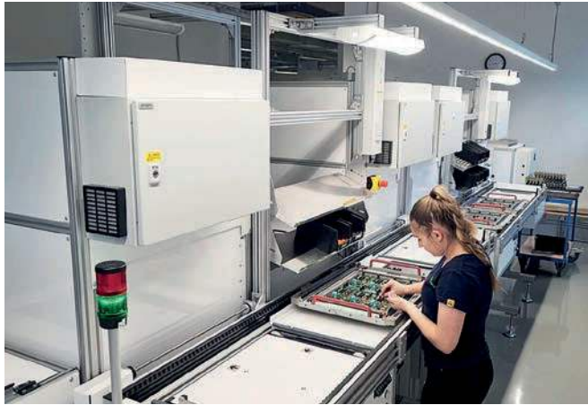
Ergonomische, individuell in der Höhe verstellbare Bestückplätze und automatische Höhenangleichstationen gehören zum Gesamtkonzept der neuen THT-Fertigungslinie bei Baudisch Electronic.
