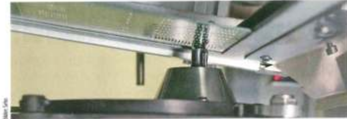
Löten im 7-Grad-Winkel: Optimaler Lotabriss und Minimierung möglicher Lötfehler.
