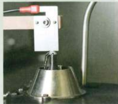
Kontrollierter Prozess: Wellenhöhenmessung und automatische Lotdrahtzuführung.
