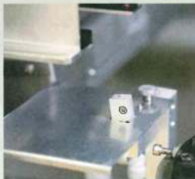
Präziser Mikrotropfenfluxer mit Funktions- und Positionsüberwachung.
