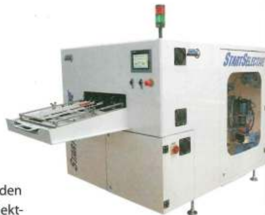
Start Selective à la plug-and-produce: Das Selektiv-Lötssystem wurde für den Einstieg in das automatisierte Löten konzipiert und ist auch für kurzfristige Kapazitätserweiterungen geeignet.
